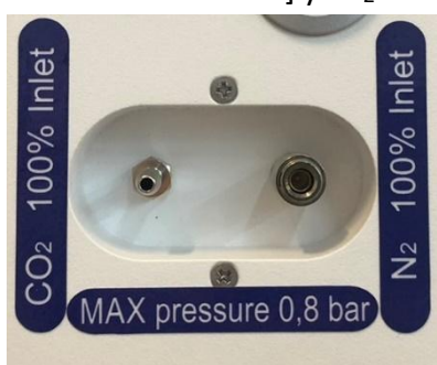
Figura 11.1 Entradas de gases en la parte posterior de la incubadora multicámara FIV MIRI® II-12
