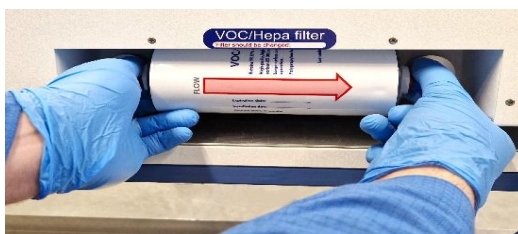
Figura 12.2 Procedimiento de inserción y extracción del filtro COV/HEPA
