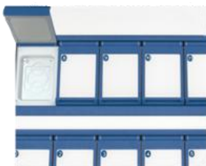
Figura 21.1 Placas de optimización térmica dentro de la cámara de la incubadora multicámara FIV MIRI® II-12
