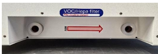
Figura 12.1 Flecha de flujo de la incubadora multicámara FIV MIRI® II-12
