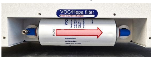
Figura 12.3 Filtro COV/HEPA correctamente instalado
